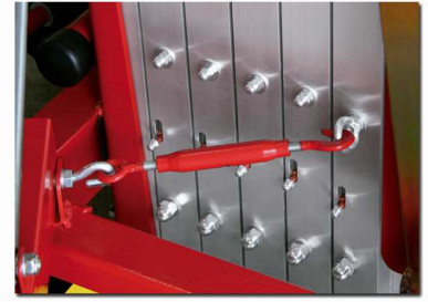
Sistema ajustable de bloqueo de los perfiles para el transporte en horizontal.
