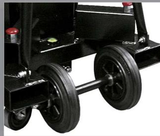
2 Ruedas reforzadas de Ø150 mm, para el transporte en posición horizontal y facilitar su carga en vehículos.
